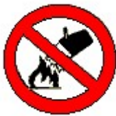
Divieto di spegnere con acqua
